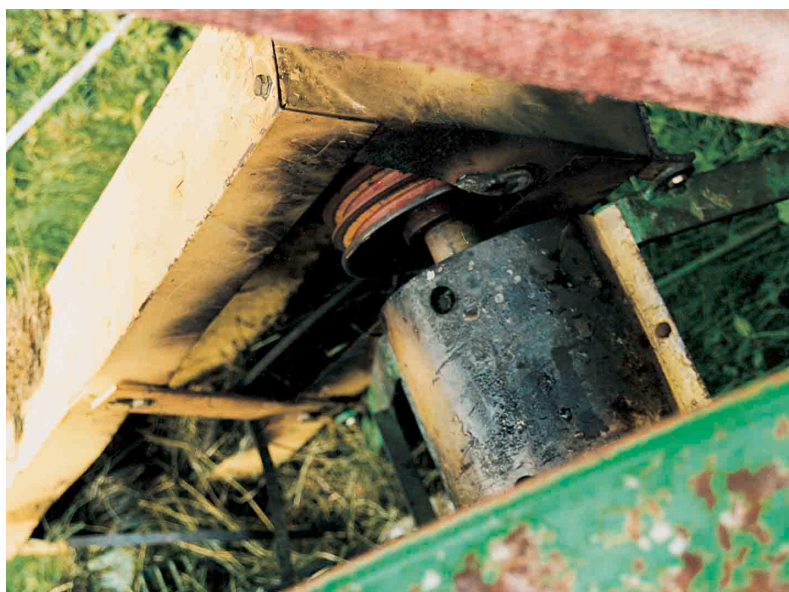
Fig. 5 - Le protezioni di cinghie non devono creare sfregamenti (rischio di esplosione della polvere)
